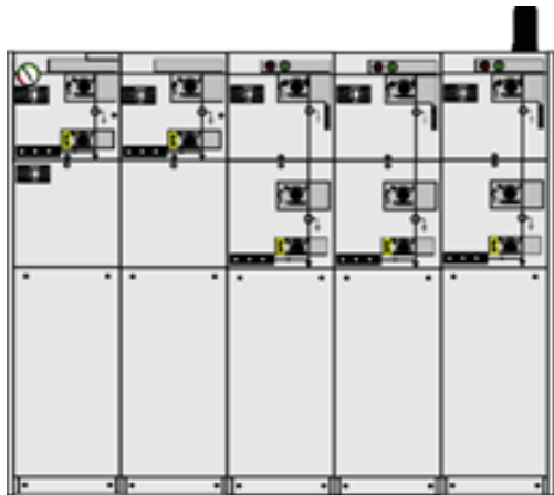
SafePlus được trang bị để sẵn sàng mở rộng về phía bên phải trong tương lai
